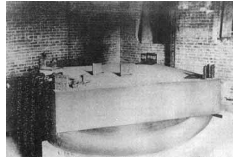
Interferómetro utilizado por Michelson y Morley para medir la velocidad de la luz.
